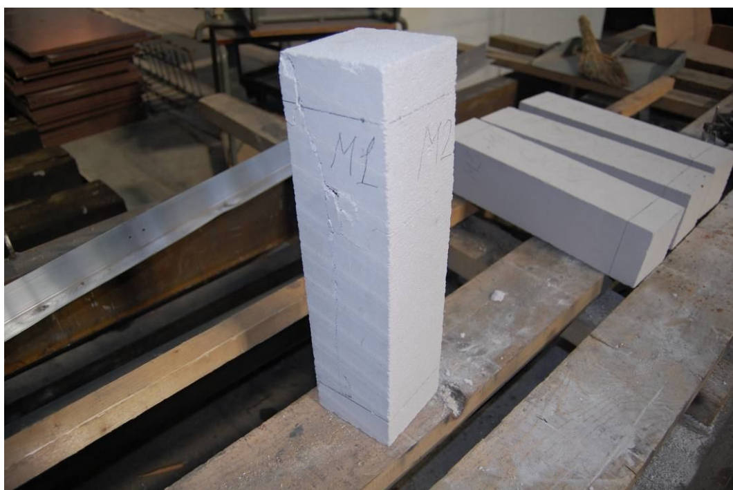
Рис.5.4. Характер разрушения опытных образцов
