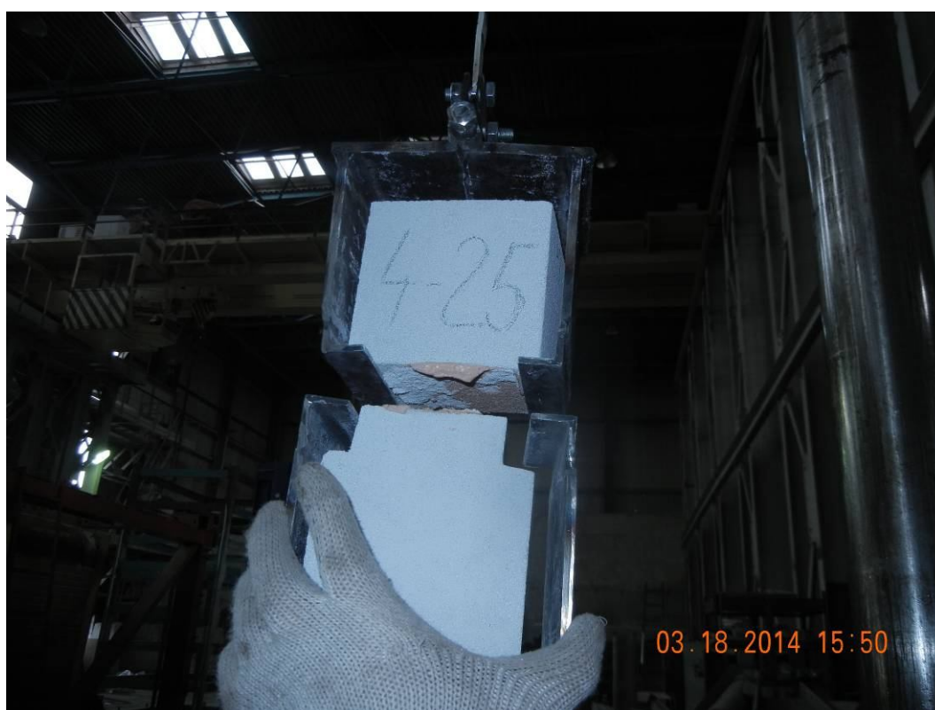
Рис.6.12. Общий вид образца серии «1÷9/4» до и после испытания на осевое растяжение (разрыв образцов по клеевому шву)
