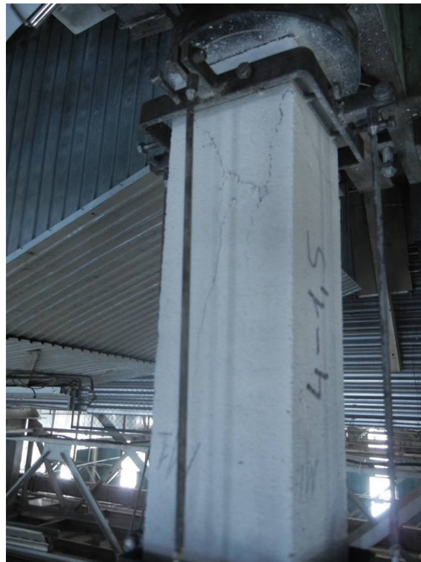
Рис.5.6. Характер разрушения опытных образцов
