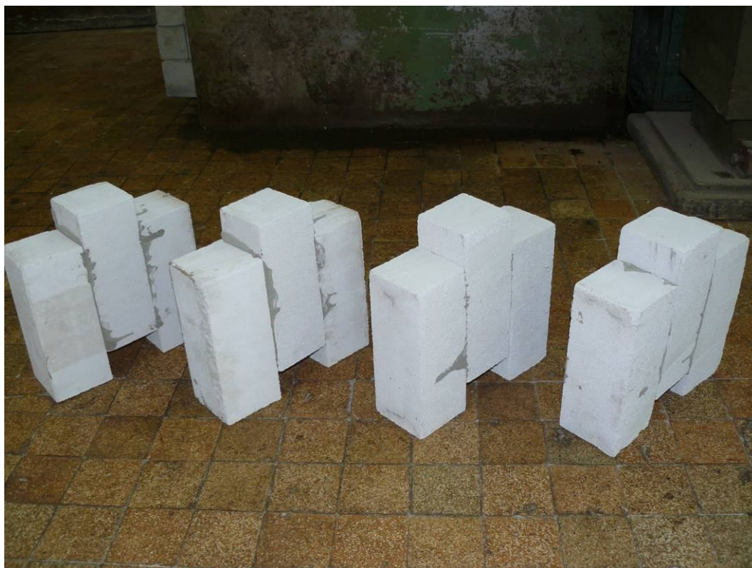
Рис. 7.2. Общий вид образцов для испытаний на срез
