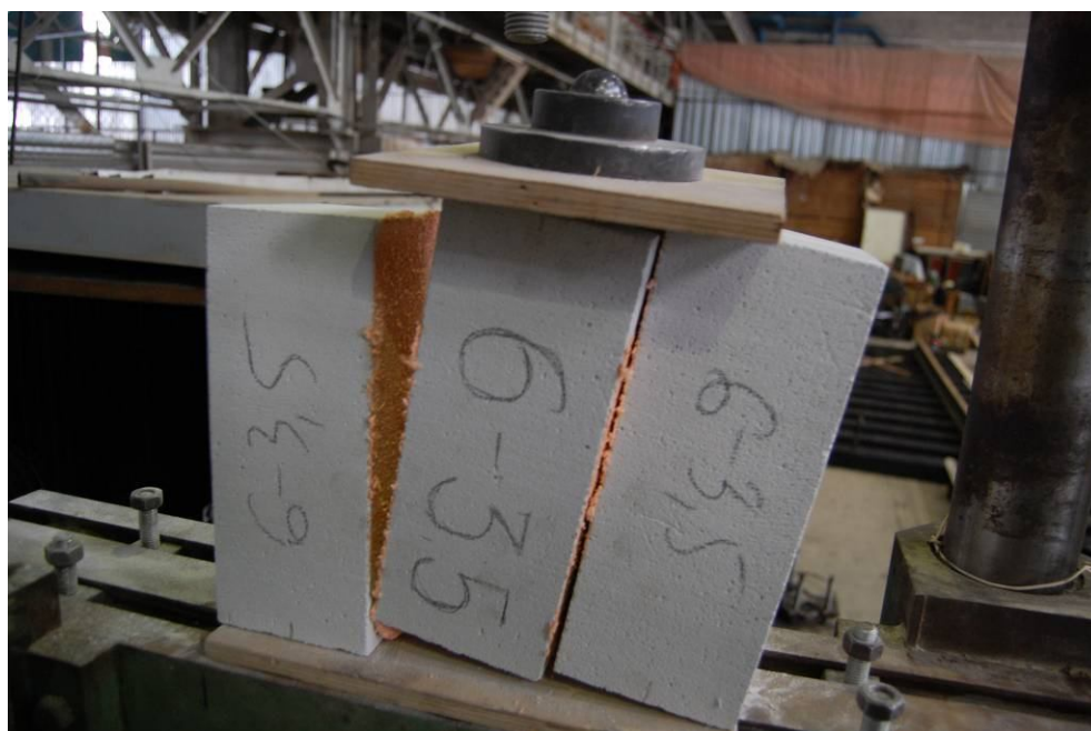
Рис.7.8. Общий вид образца серии «1÷9/4» до и после испытания на срез (разрыв образцов по клеевому шву)
