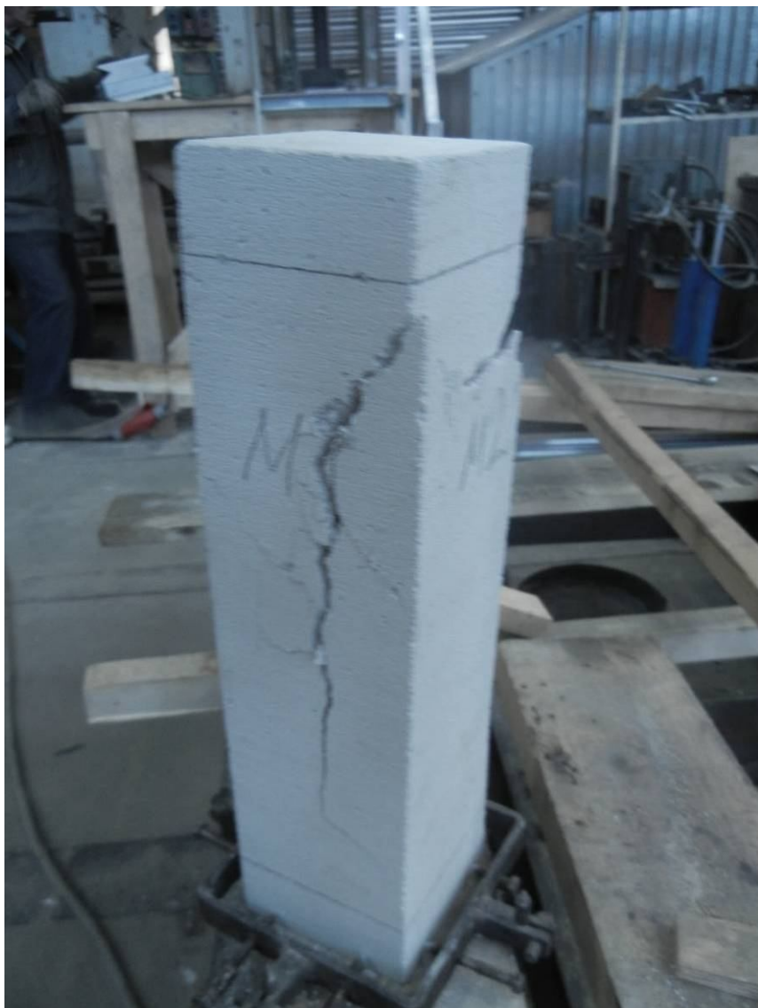
Рис.5.5. Характер разрушения опытных образцов
