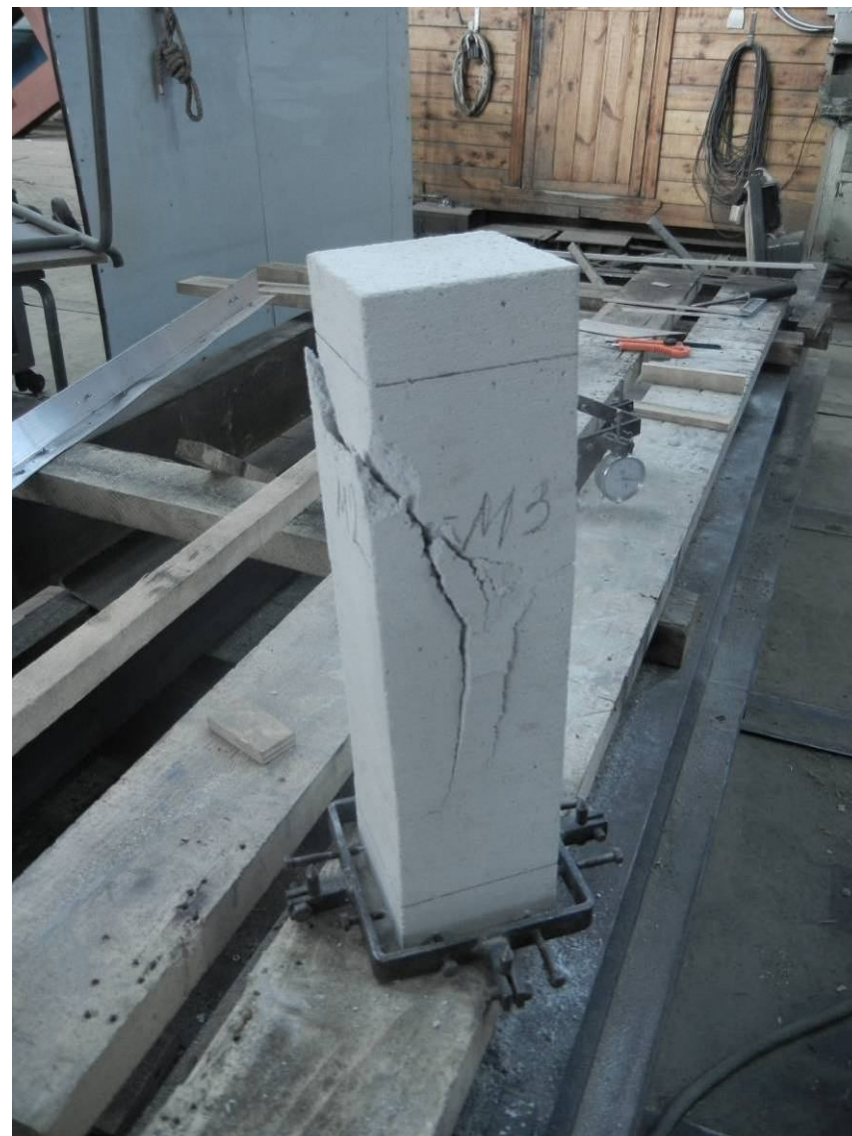
Рис.5.5. Характер разрушения опытных образцов
