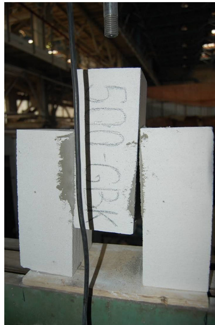
Рис.7.4. Общий вид образца серии «1÷9/1» до и после испытания на срез
