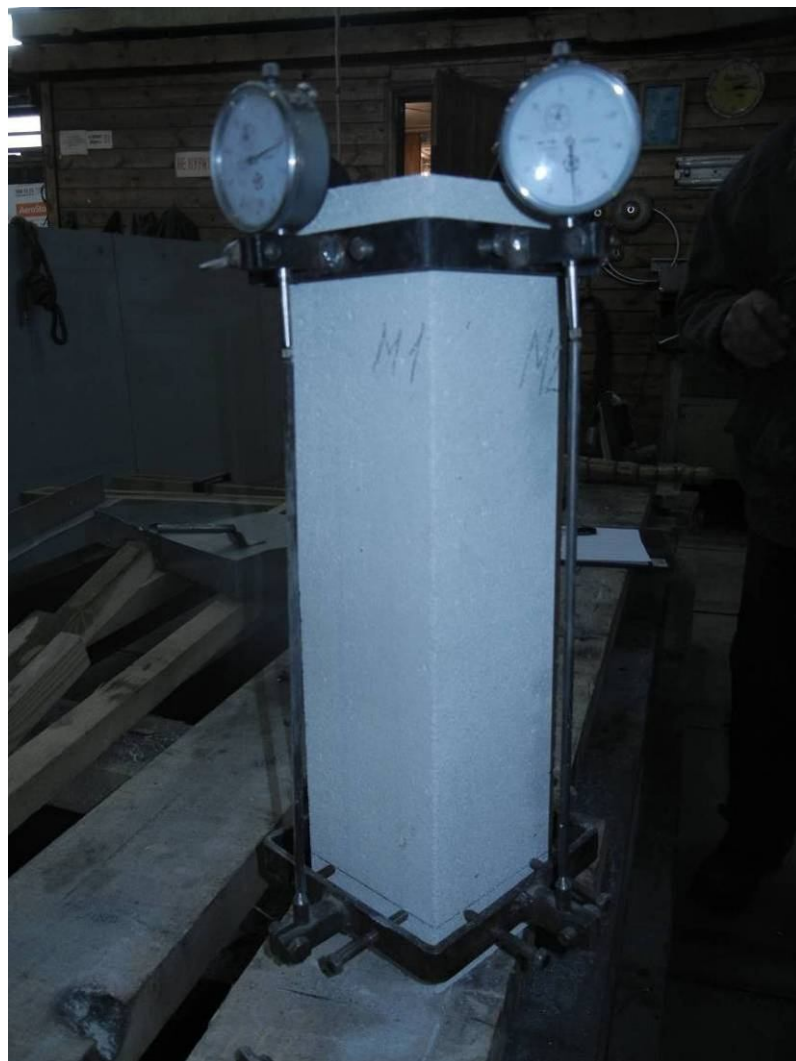
Рис.5.2. Общий вид опытных образцов с установленными индикаторами часового типа
