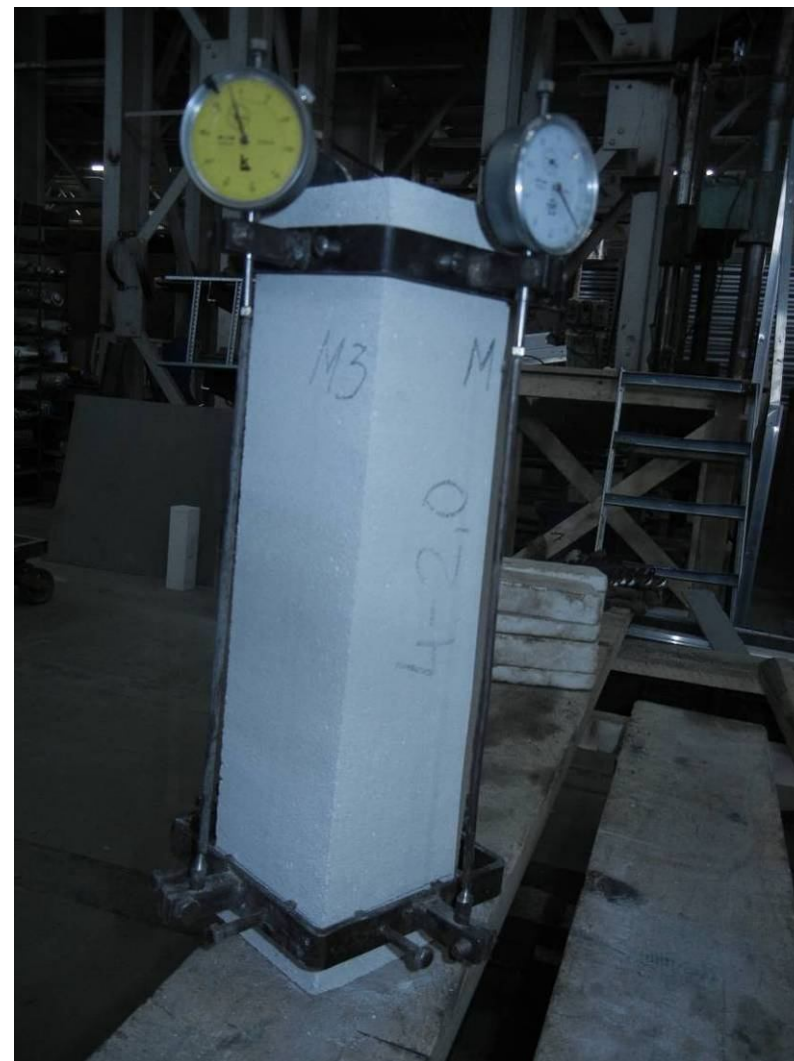
Рис.5.2. Общий вид опытных образцов с установленными индикаторами часового типа
