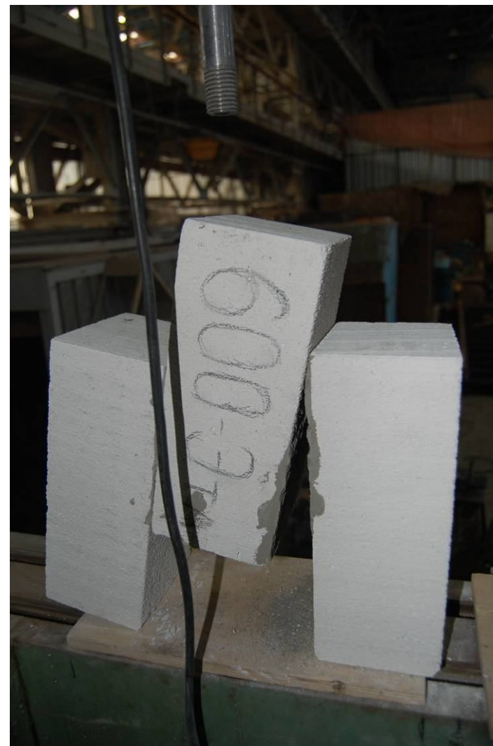
Рис.7.7. Общий вид образца серии «1÷9/3» до и после испытания на срез
