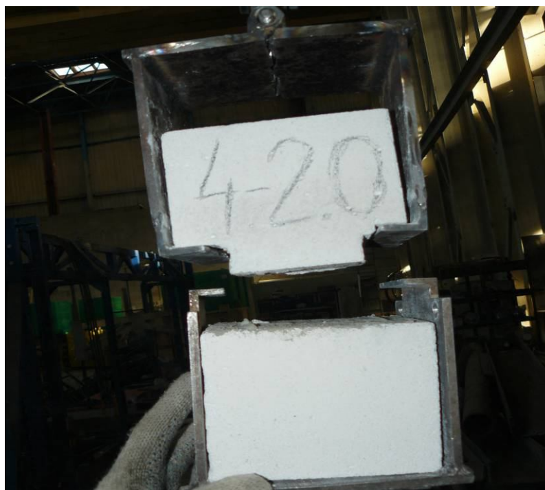
Рис.6.9. Общий вид образца серии «1÷9/2» до и после испытания на осевое растяжение (разрыв образцов по клеевому шву)
