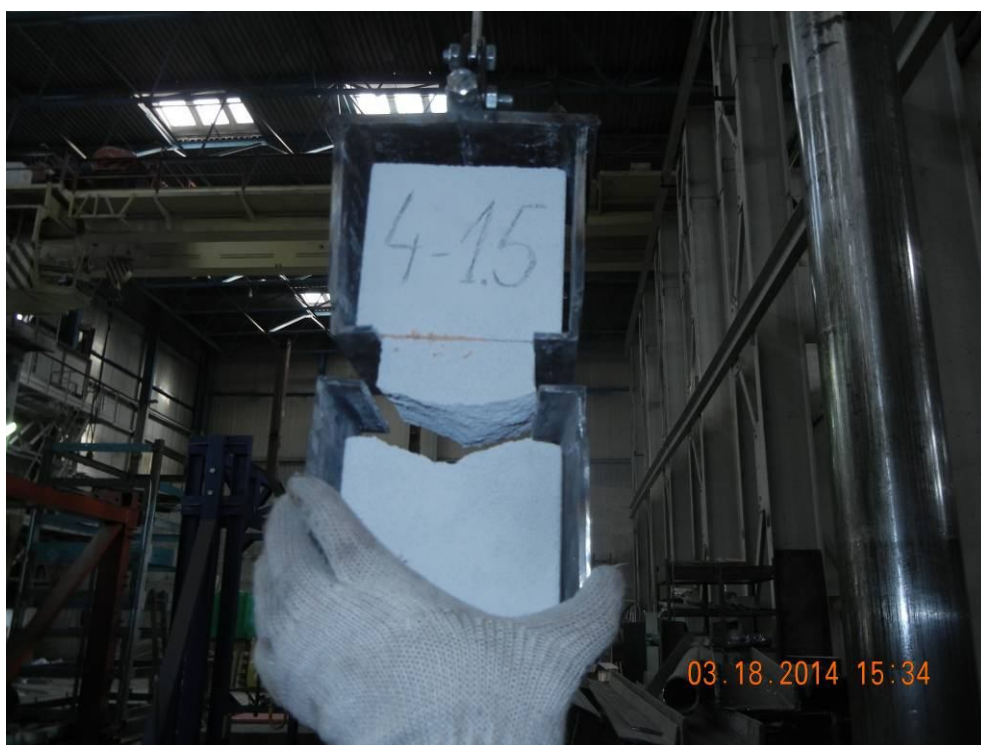
Рис.6.11. Общий вид образца серии «1÷9/4» до и после испытания на осевое растяжение (разрыв образцов по «телу» призмы)
