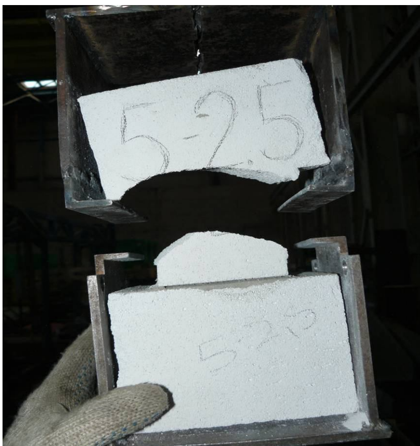
Рис.6.8. Общий вид образца серии «1÷9/2» до и после испытания на осевое растяжение (разрыв образцов по «телу» призмы)
