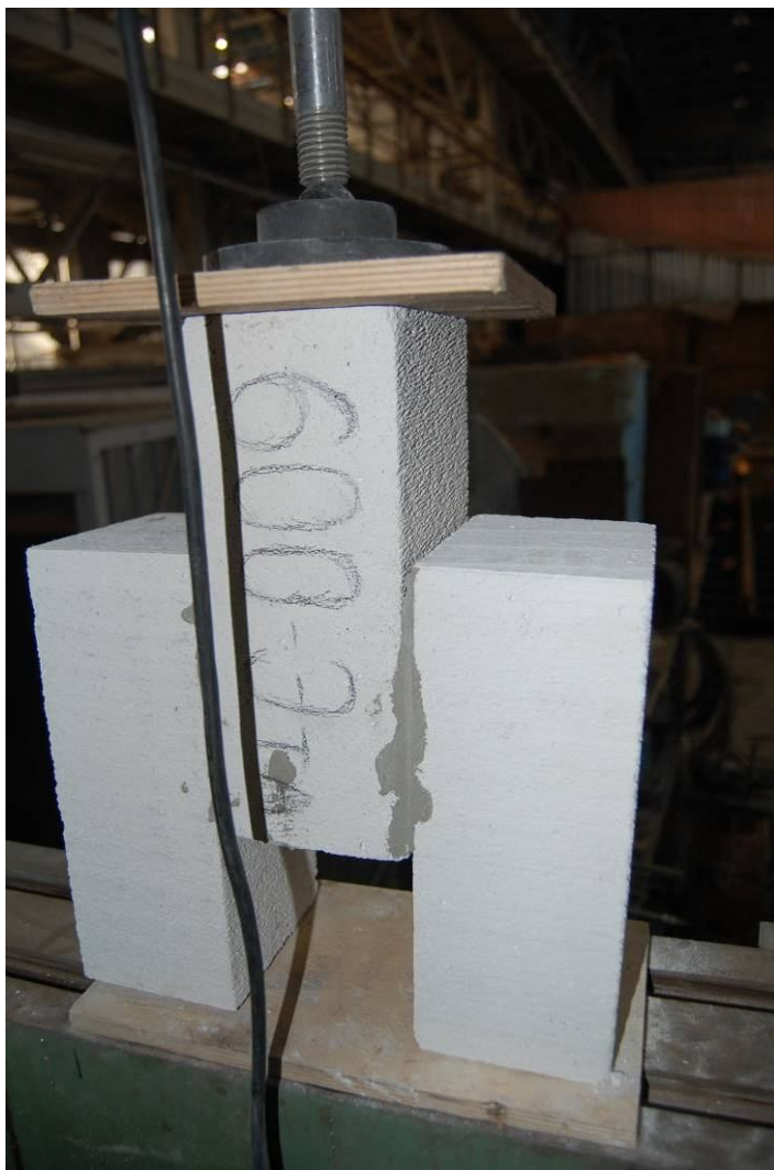
Рис.7.7. Общий вид образца серии «1÷9/3» до и после испытания на срез
