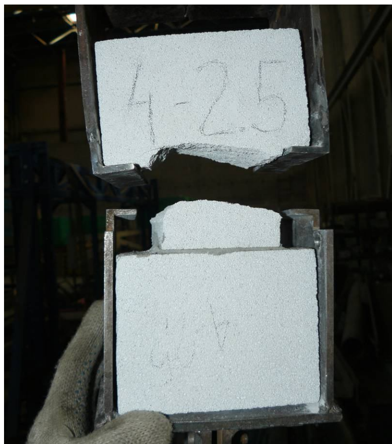
Рис.6.7. Общий вид образца серии «1÷9/1» до и после испытания на осевое растяжение (разрыв образцов по «телу» призмы)
