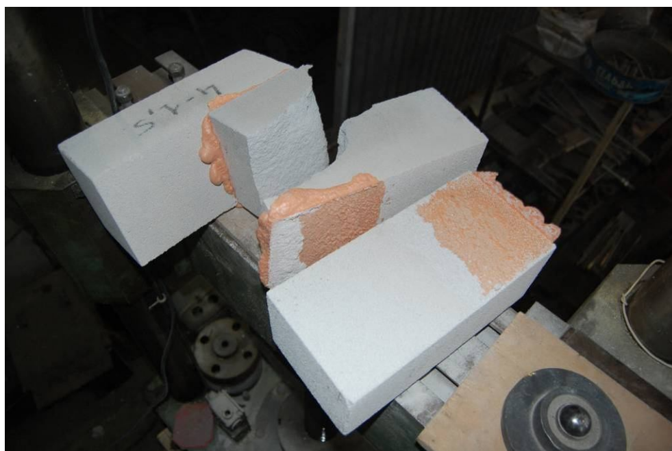
Рис.7.9. Общий вид образца серии «1÷9/4» до и после испытания на срез (разрыв образцов по «телу» призмы)
