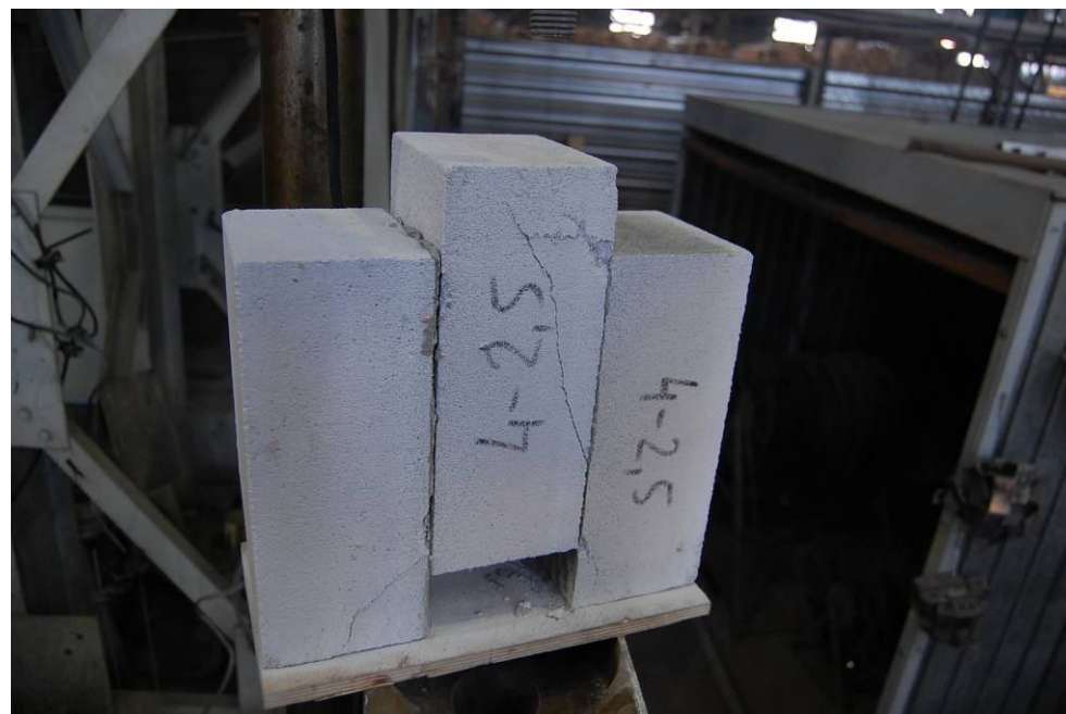
Рис.7.6. Общий вид образца серии «1÷9/2» после испытания на срез (разрыв образцов по «телу» призмы)
