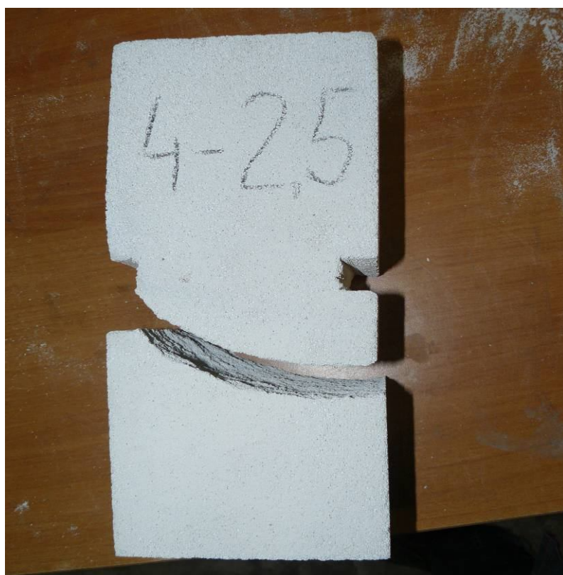
Рис.6.5. Общий вид образцов серии «1÷9/0» после испытания на осевое растяжение, плоскость разрушения которых, наклонена к горизонтальной оси призмы более чем на 15%
