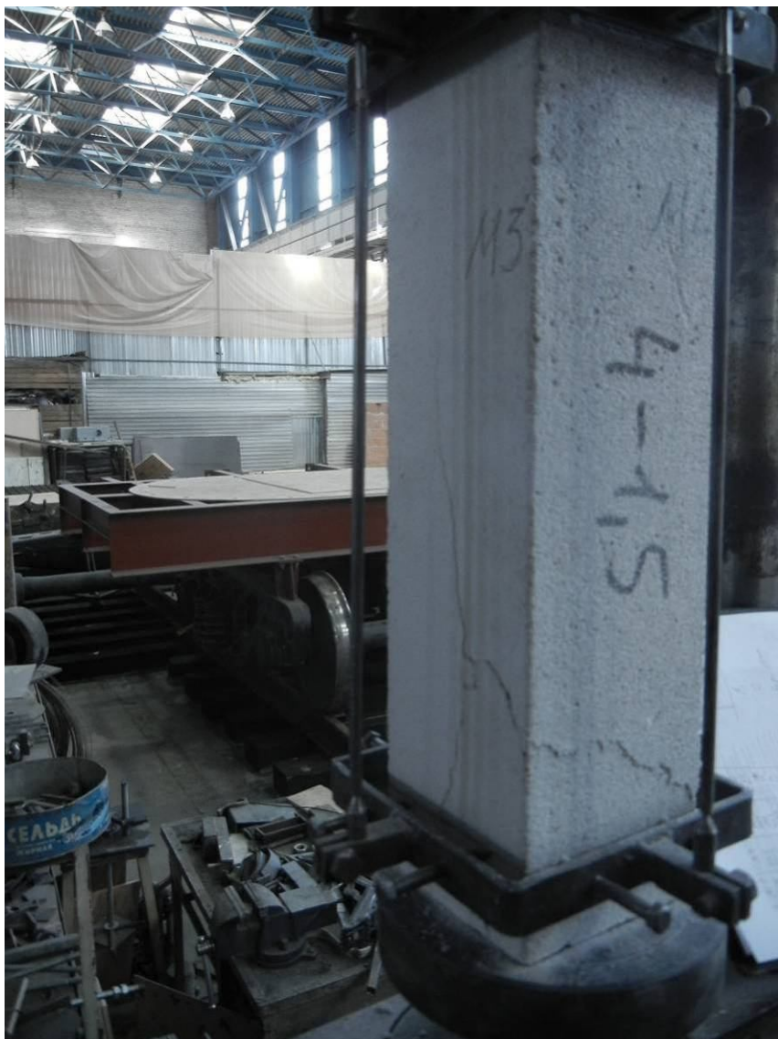
Рис.5.6. Характер разрушения опытных образцов
