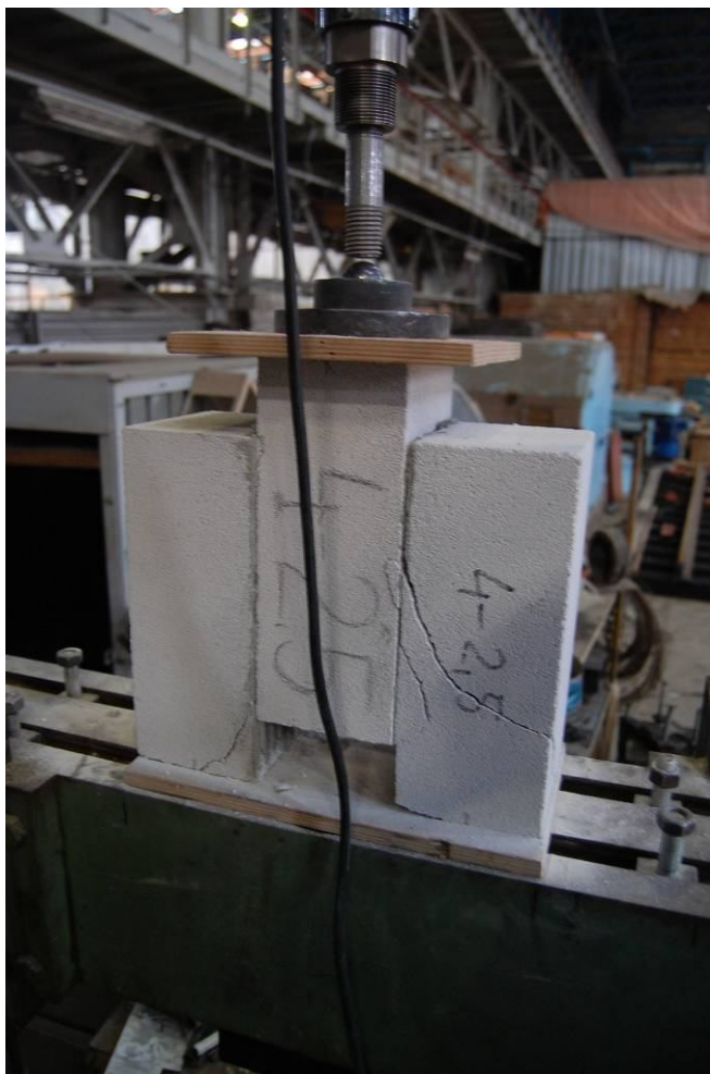
Рис.7.6. Общий вид образца серии «1÷9/2» после испытания на срез (разрыв образцов по «телу» призмы)
