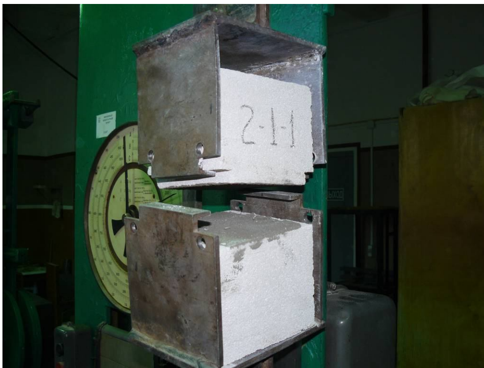
Рис.6.6. Общий вид образца серии «1÷9/1» до и после испытания на осевое растяжение (разрыв образцов по клеевому шву)
