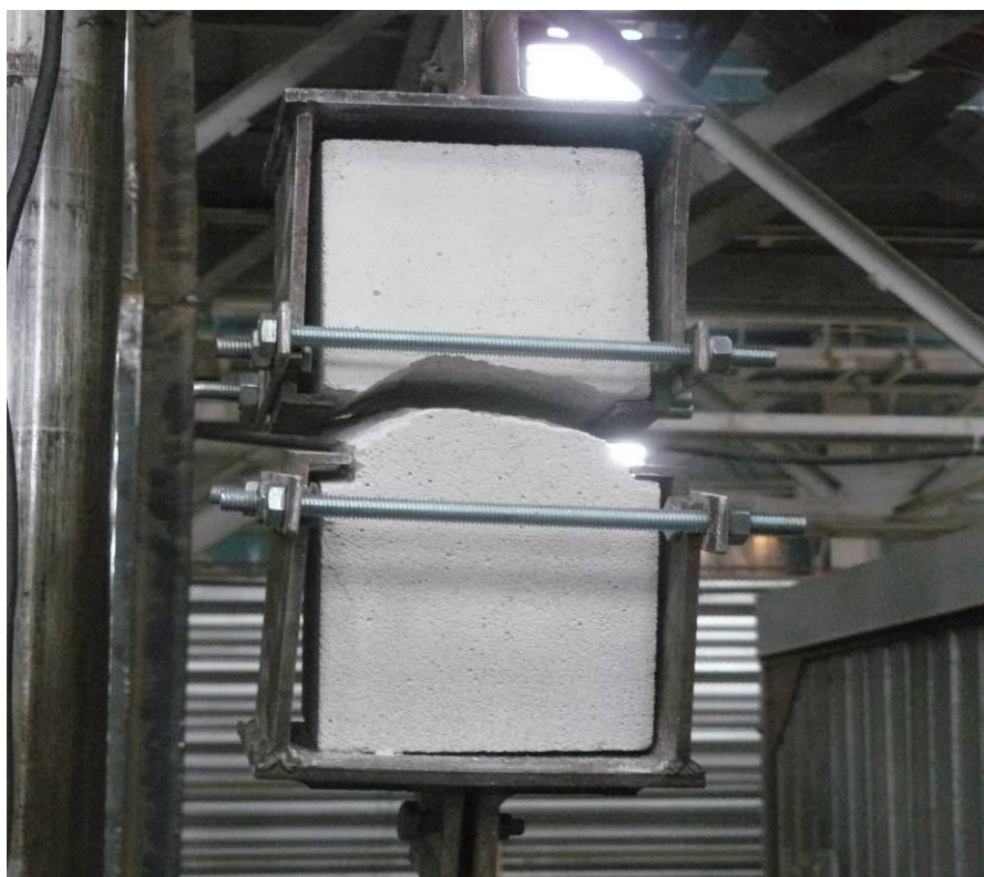
Рис.6.4. Общий вид образца серии «1÷9/0» до и после испытания на осевое растяжение
