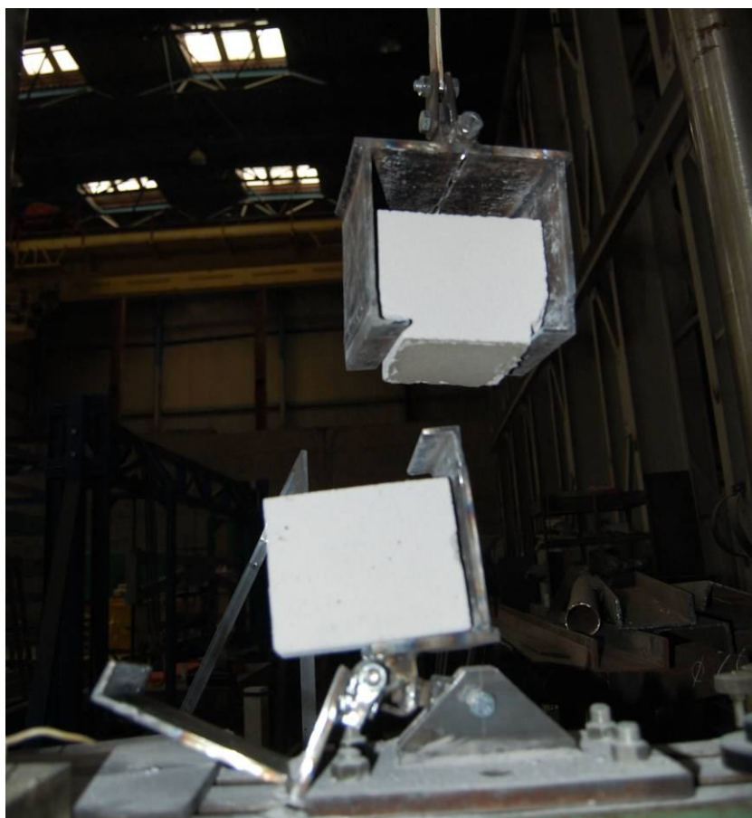
Рис.6.10. Общий вид образца серии «1÷9/3» до и после испытания на осевое растяжение (разрыв образцов по клеевому шву)
