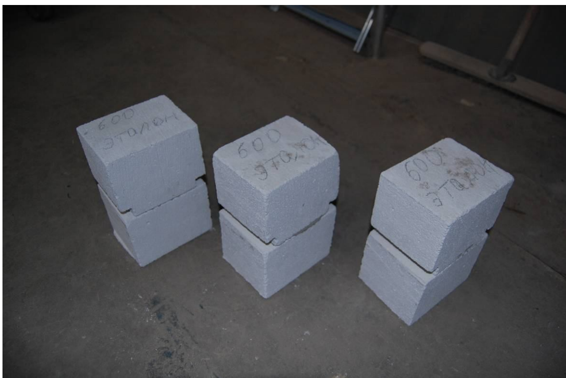
Рис. 6.2. Общий вид образцов для испытаний на осевое растяжение
