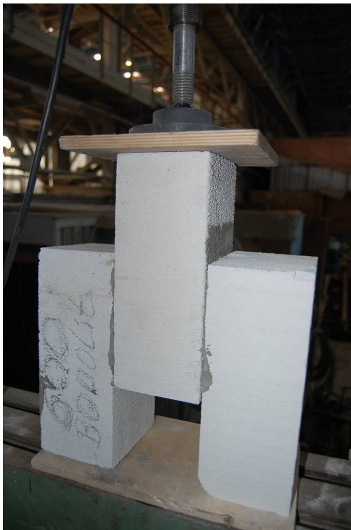
Рис.7.5. Общий вид образца серии «1÷9/2» до и после испытания на срез (разрыв образцов по клеевому шву)
