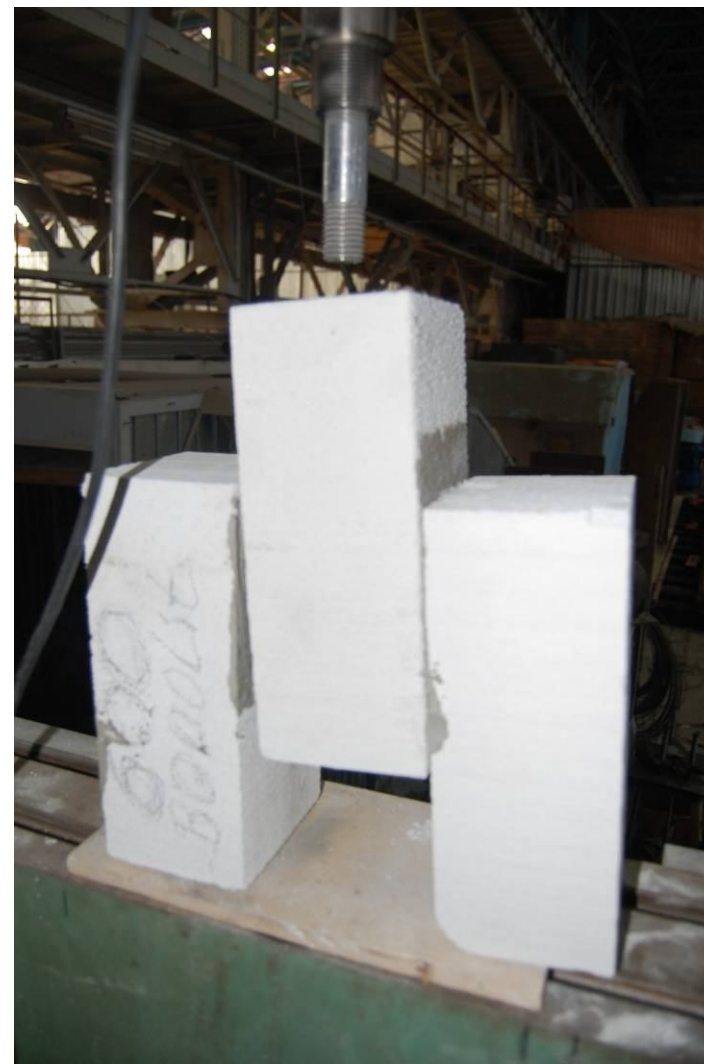
Рис.7.5. Общий вид образца серии «1÷9/2» до и после испытания на срез (разрыв образцов по клеевому шву)
